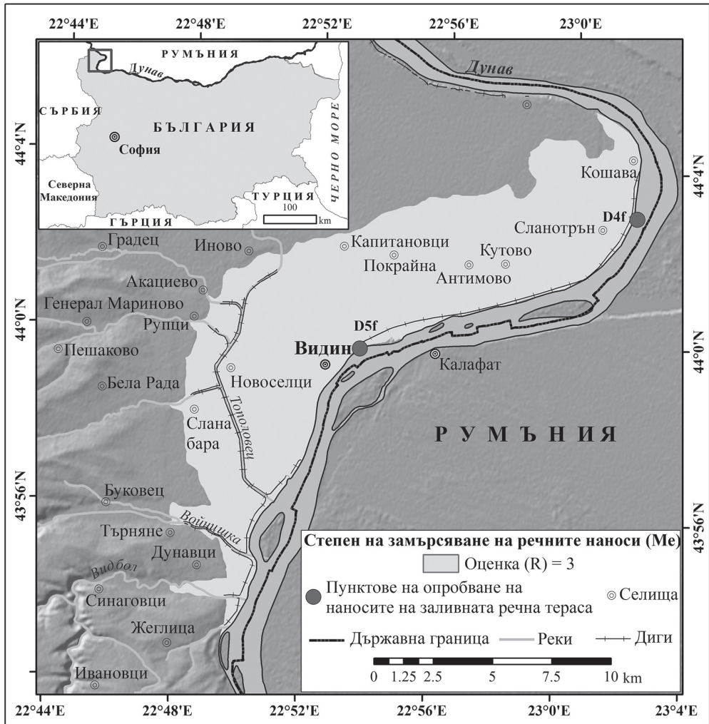
Фиг. 2. Карта на оценката (R) на степента на замърсяване на речните наноси (Me)
